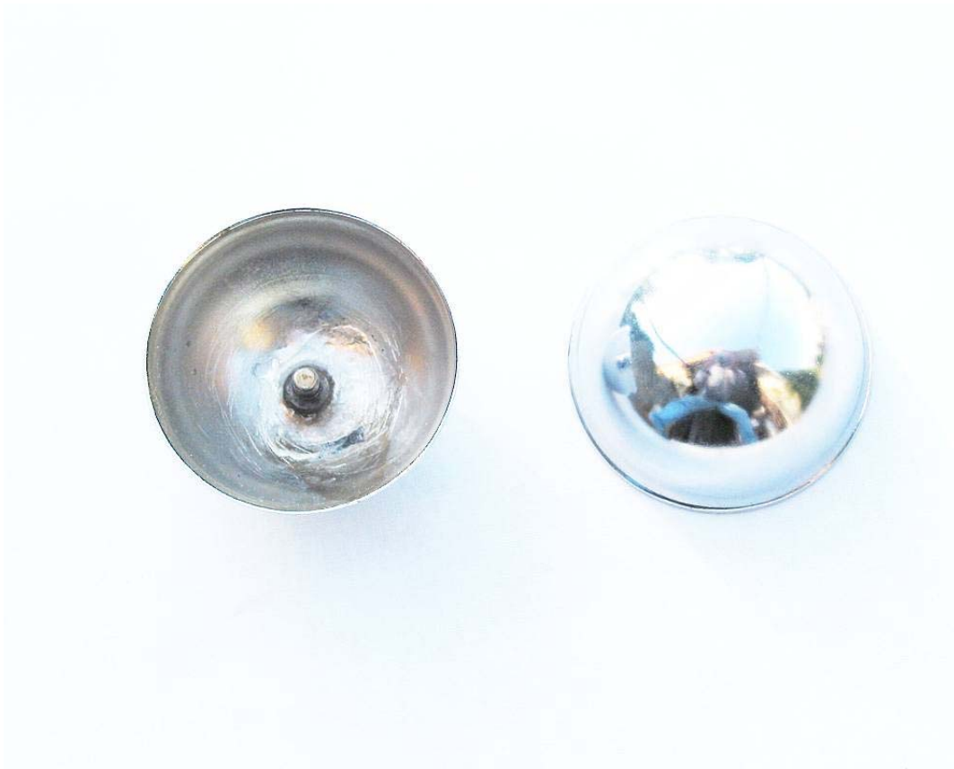
Takto vypadají krycí půlmisky, vyrobené z krytky náboje kola
