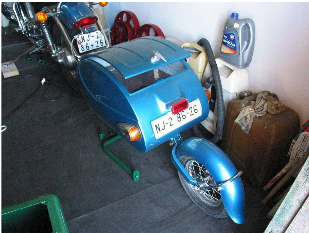
Blinkry VW Brouk, uzamykatelná klika AVIA, původní vložka FAB vyměněna za uplavenou vložku ze zámku přílby – stejný klíček je i pro zámek řízení ☺.
