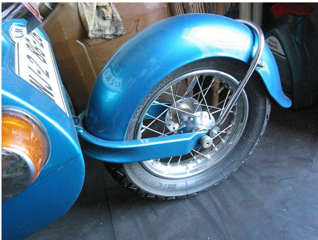
Nové kolo PAV, blatník z okapového kolena
