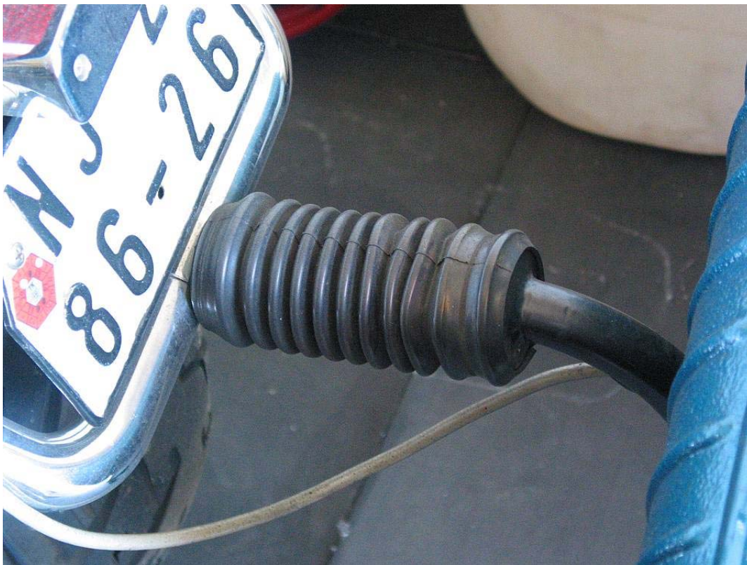
Kloub schovaný v gumové manžetě. Vpravo je pod gumou natáčecí spojka, vlevo je guma přetažena přes půlmisku.
