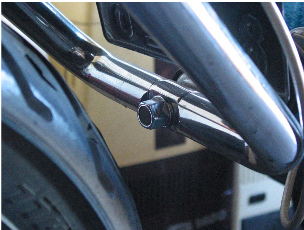
Detail matice svorníku, stahujícího obě půlky závěsu, pod RZ vyčuhuje část půlmisky
