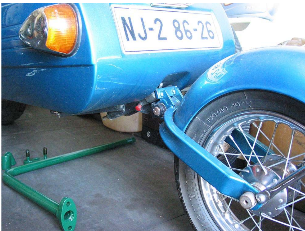
Ložisko vidlice tvoří gumový silentblok z přední nápravy ŠKODA 105/120
